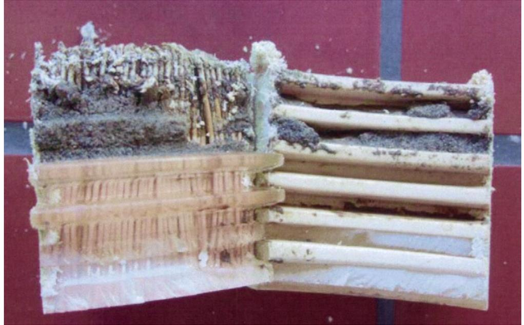
**Bild 1.** Latente Ablagerungen im Bereich des Pottings. Alle Abbildungen: Hydro-Elektrik GmbH
